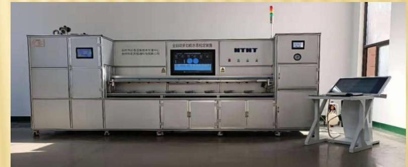
全自动多功能水表检定装置是公司合作研制的全新设备，流量采用质量法原理，对无线水表、光电水表、机械水表均实现一步检定完成，准确度达到0.2级。水表表号、流量数据、电气参数均自动读取，全自动处理并自动生成检定报告。设备通用性好、效率高、操作简单、维护方便，无需更改即可满足不同水表的检定要求。
