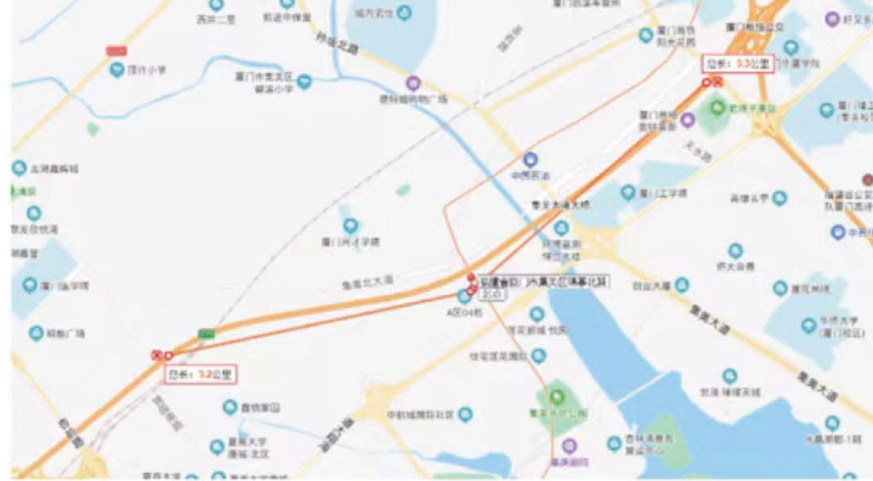
场外移动测试：100km/h移动速度，600bps通信速率，10dBm发射功率，6.5km通信范围
